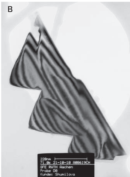
Данные просвечивающей электронной микроскопии лонсдейлита из Кумдыкольского месторождения:
